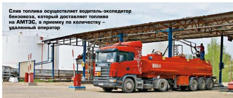
**Слив топлива осуществляет водитель-экспедитор бензовоза, который доставляет топливо на АМТЗС, а приемку по количеству – удаленный оператор**
